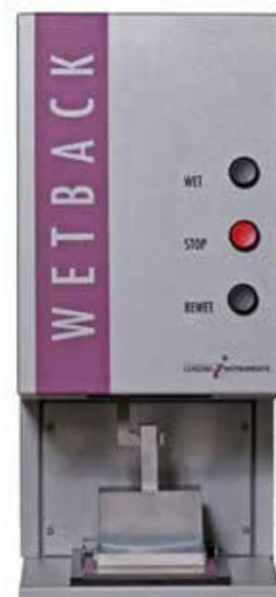
Bestimmung der Rücknässung von Vliesstoffen in Konformität zu EDANA/INDA Standards NWSP 80.10. (Lenzing Instruments WETBACK) | Determination of the rewet properties of nonwoven coverstocks according to EDANA/INDA standards NWSP 80.10. (Lenzing Instruments WETBACK)
