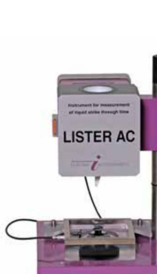
Gerät für die automatische Messung der Flüssigkeitspenetration von Vliesstoffen in Konformität zu EDANA/INDA Standards NWSP 70.3 und NWSP 70.7. (Lenzing Instruments LISTER AC) | Instrument for automatic measurement of liquid strike-through time of nonwoven coverstocks according to EDANA/INDA-standards NWSP 70.3 and NWSP 70.7. (Lenzing Instruments LISTER AC)
