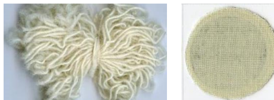
Abb1 Verhinderung der Filzneigung von WO bei 98°C.
